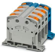
Hochstromklemme, geblockt, Nennspannung: 1000 V, Nennstrom: 309 A, Anzahl der Anschlüsse: 8, Polzahl: 4, Anschlussart: PowerTurn-Anschluss, 1. Etage, Querschnitt: 95 mm<sup>2</sup> - 185 mm<sup>2</sup>, Montageart: direktes Anschrauben, Farbe: grau/blau
