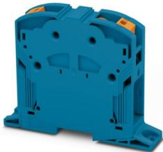
Hochstromklemme, Nennspannung: 1000 V, Nennstrom: 309 A, Anzahl der Anschlüsse: 2, Polzahl: 1, Anschlussart: PowerTurn-Anschluss, 1. Etage, Querschnitt: 95 mm<sup>2</sup> - 185 mm<sup>2</sup>, Montageart: direktes Anschrauben, Farbe: blau
