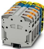
Hochstromklemme, geblockt, Nennspannung: 1000 V, Nennstrom: 309 A, Anzahl der Anschlüsse: 10, Polzahl: 5, Anschlussart: PowerTurn-Anschluss, 1. Etage, Querschnitt: 95 mm<sup>2</sup> - 185 mm<sup>2</sup>, Montageart: NS 35/15, Farbe: grau/blau/schwarz-gelb
