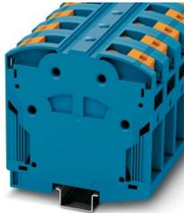
Hochstromklemme, mit Prüfbuchse, Nennspannung: 1000 V, Nennstrom: 309 A, Anzahl der Anschlüsse: 2, Polzahl: 1, Anschlussart: PowerTurn-Anschluss, 1. Etage, Querschnitt: 95 mm<sup>2</sup> - 185 mm<sup>2</sup>, Montageart: NS 35/15, Farbe: blau
