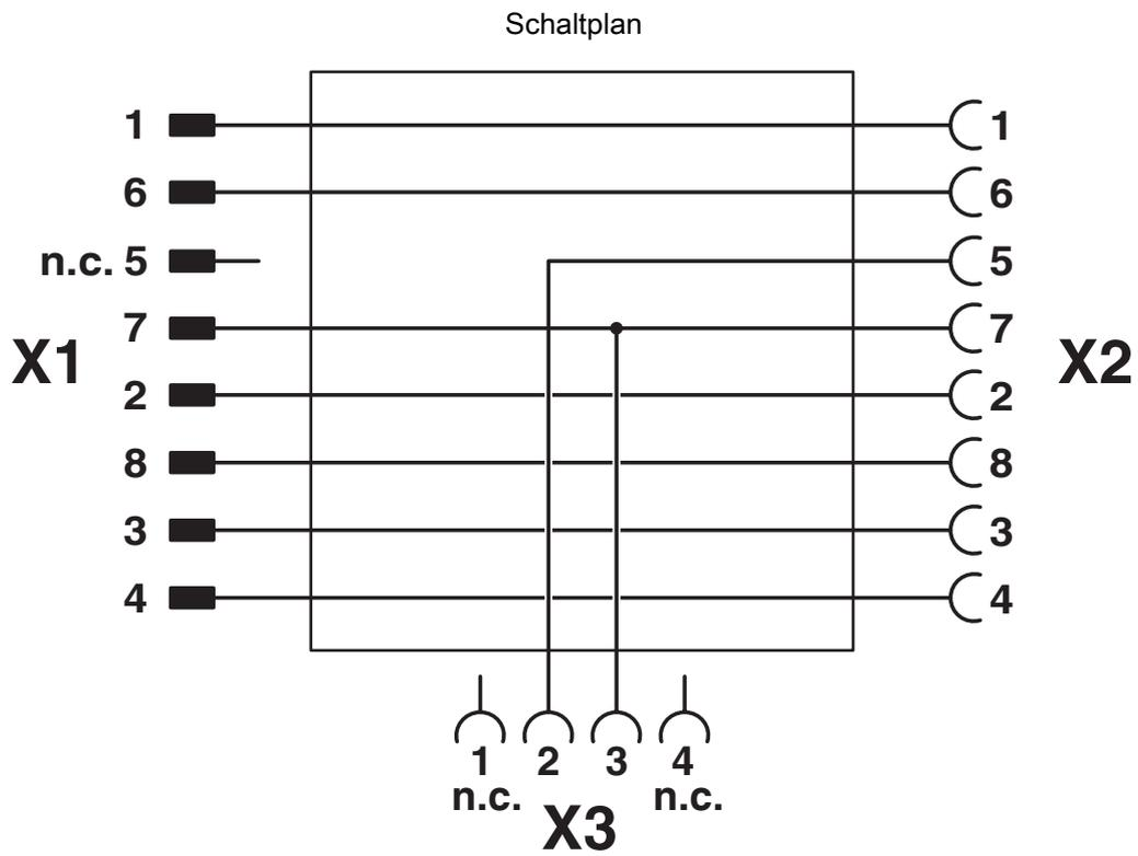
Kontaktbelegung des M12-Y-Verteilers
