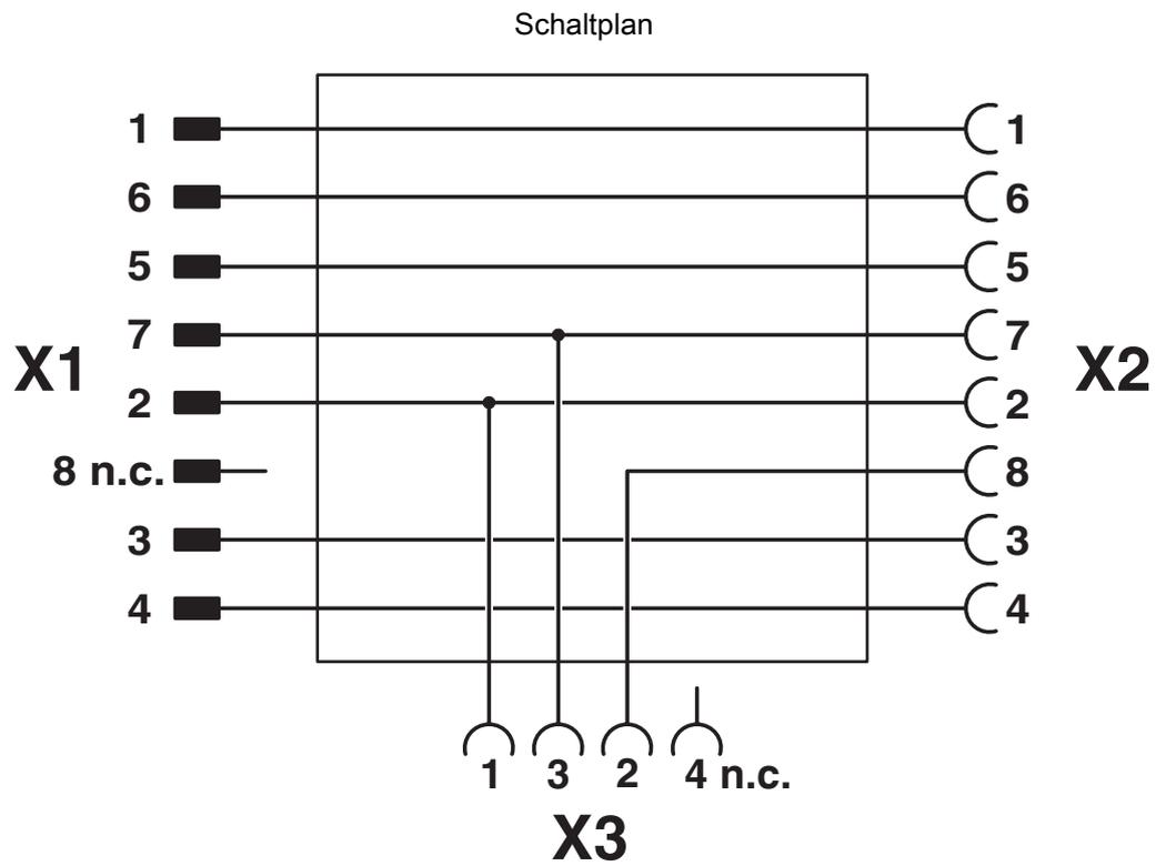
Kontaktbelegung des M12-Y-Verteilers
