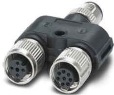
Y-Verteiler für RFID-Transponderschalter der Serie PSR-CT, M12-Stecker/Buchse, 5- und 8-polig, für die Realisierung eines manuellen Startkreises im Feld
