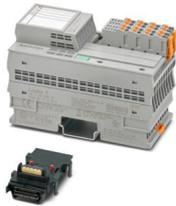
Axioline P, Analogeingabemodul, Aktive analoge Eingänge: 8 (HART), 4 mA ... 20 mA, Anschluss technik: 2-Leiter, Übertragungsgeschwindigkeit im Lokalbus: 100 MBit/s, HART-Funktionalität, Schutzart: IP20, inklusive Bussockelmodul und Axioline P-Steckern
