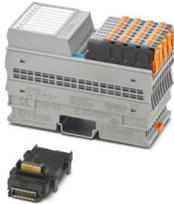
Axioline F, Digitaleingabemodul, Digitale Eingänge: 16 (NAMUR), 8 V DC, Anschlusstechnik: 2-Leiter, Extreme Conditions-Variante, Übertragungsgeschwindigkeit im Lokalbus: 100 MBit/s, Schutzart: IP20, inklusive Bussockelmodul und Axioline F-Steckern
