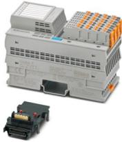
Axioline P, Digitaleingabemodul, Digitale Eingänge: 16 (NAMUR), 8 V DC, Anschlusstechnik: 2-Leiter, NAMUR-Funktionalität, Übertragungsgeschwindigkeit im Lokalbus: 100 MBit/s, Schutzart: IP20, inklusive Bussockelmodul und Axioline P-Steckern
