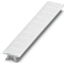
Marker für Klemmen, Streifen, weiß, beschriftet, längs bedruckt: fortlaufende Zahlen, Montageart: verrasten, für Klemmenbreite: 6,2 mm, Anzahl der Einzelschilder: 10, Textfeldhöhe: 10,5 mm, Textfeldbreite: 6,15 mm
