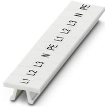
Zackband, Streifen, weiß, beschriftet, längs: L1, L2, L3, N, PE, L1, L2, L3, N, PE, Montageart: verrasten, für Klemmenbreite: 5,2 mm, Anzahl der Einzelschilder: 10, Textfeldhöhe: 10,5 mm, Textfeldbreite: 5,15 mm
