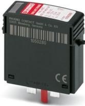
Überspannungsschutzstecker Typ 2 mit Reihenschaltung aus Varistor und gasgefüllter Funkenstrecke für VAL-MS-Basiselement, thermisch überwacht, optische Defektmeldung. Ausführung: 350 V AC mit erhöhtem Blitzstrom-Ableitvermögen.
