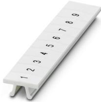
Zackband, Streifen, weiß, beschriftet, längs bedruckt: fortlaufende Zahlen 1 ... 9, Montageart: verrasten, für Klemmenbreite: 5,2 mm, Anzahl der Einzelschilder: 10, Textfeldhöhe: 10,5 mm, Textfeldbreite: 5,15 mm
