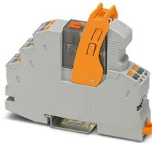
Vormontiertes Relaismodul mit Push-in-Anschluss, bestehend aus: Relaissockel, Leistungskontaktrelais, steckbarem Anzeige-/ Entstörm modul und Haltebügel. Kontaktausführung: 2 Wechsler. Eingangsspannung: 24 V AC
