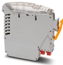
Leitungsüberwachungsmodul für VIP I/O-Marshalling-Basiselemente. Ermöglicht eine Leitungsfehlerüberwachung bei Nutzung von Standard-Schaltkontakten in Sicherheitsanwendungen. Es können sowohl Drahtbrüche als auch Kurzschlüsse erkannt werden.
