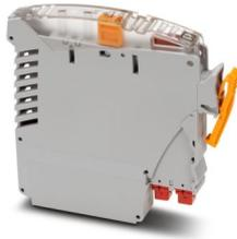
Sicherungsmodul für VIP I/O-Marshalling-Basiselemente mit austauschbarer 2-A-Sicherung im Feldgeräte-Versorgungspfad. Integrierte Testpunkte und ein Trennmesser erlauben die unterbrechungsfreie Signalmessung. HART-transparent.
