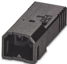
Leiterplattenstecker, Nennquerschnitt: 0,75 mm<sup>2</sup>, Farbe: schwarz, Nennstrom: 6 A, Bemessungsspannung (III/2): 160 V, Kontaktart: Stift, Anzahl der Potenziale: 8, Anzahl der Reihen: 1, Polzahl: 8, Anzahl der Anschlüsse: 8, Artikelfamilie: PTCM 0,5/..-PI, Rastermaß: 2,5 mm, Anschlussart: Crimpanschluss, Anschlussrichtung Leiter/Platine: 0 °, Stecksystem: COMBICON PTSM, Verriegelung: Rastverriegelung, Befestigungsart: Rastnase, Verpackungsart: verpackt im Karton
