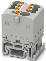
Verteilerblock, Block mit waagerechter Ausrichtung und integrierter Einspeisung, Nennspannung: 500 V, Nennstrom: 17,5 A, Anzahl der Anschlüsse: 7, Anschlussart: Push-in-Anschluss, Abgriff, Querschnitt: 0,14 mm<sup>2</sup> - 2,5 mm<sup>2</sup>, Sammelanschluss, Bemessungsquerschnitt: 4 mm<sup>2</sup>, Querschnitt: 0,2 mm<sup>2</sup> - 6 mm<sup>2</sup>, Montageart: NS 15, Farbe: grau
