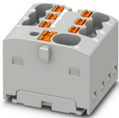
Verteilerblock, Grundklemme mit Einspeisung, Nennspannung: 450 V, Nennstrom: 17,5 A, Anzahl der Anschlüsse: 7, Anschlussart: Push-in-Anschluss, Abgriff, Querschnitt: 0,14 mm<sup>2</sup> - 2,5 mm<sup>2</sup>, Sammelschluss, Bemessungsquerschnitt: 4 mm<sup>2</sup>, Querschnitt: 0,2 mm<sup>2</sup> - 6 mm<sup>2</sup>, Montageart: kleben, Farbe: grau
