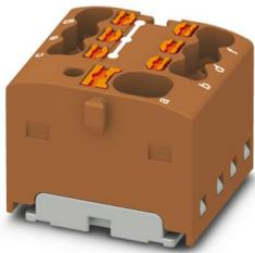
Verteilerblock, Grundklemme mit Einspeisung, Nennspannung: 450 V, Nennstrom: 17,5 A, Anzahl der Anschlüsse: 7, Anschlussart: Push-in-Anschluss, Abgriff, Querschnitt: 0,14 mm<sup>2</sup> - 2,5 mm<sup>2</sup>, Sammelschluss, Bemessungsquerschnitt: 4 mm<sup>2</sup>, Querschnitt: 0,2 mm<sup>2</sup> - 6 mm<sup>2</sup>, Montageart: aufrasten auf Tragschienenadapter, Direktmontage mit Flansch, Fliegend, Farbe: braun
