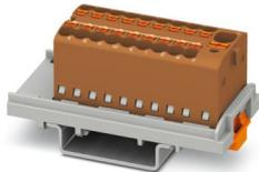
Verteilerblock, Nennspannung: 500 V, Nennstrom: 17,5 A, Anzahl der Anschlüsse: 19, Anschlussart: Push-in-Anschluss, Abgriff, Querschnitt: 0,14 mm<sup>2</sup> - 2,5 mm<sup>2</sup>, Sammelschluss, Bemessungsquerschnitt: 4 mm<sup>2</sup>, Querschnitt: 0,2 mm<sup>2</sup> - 6 mm<sup>2</sup>, Montageart: NS 35/7,5, NS 35/15, Farbe: braun
