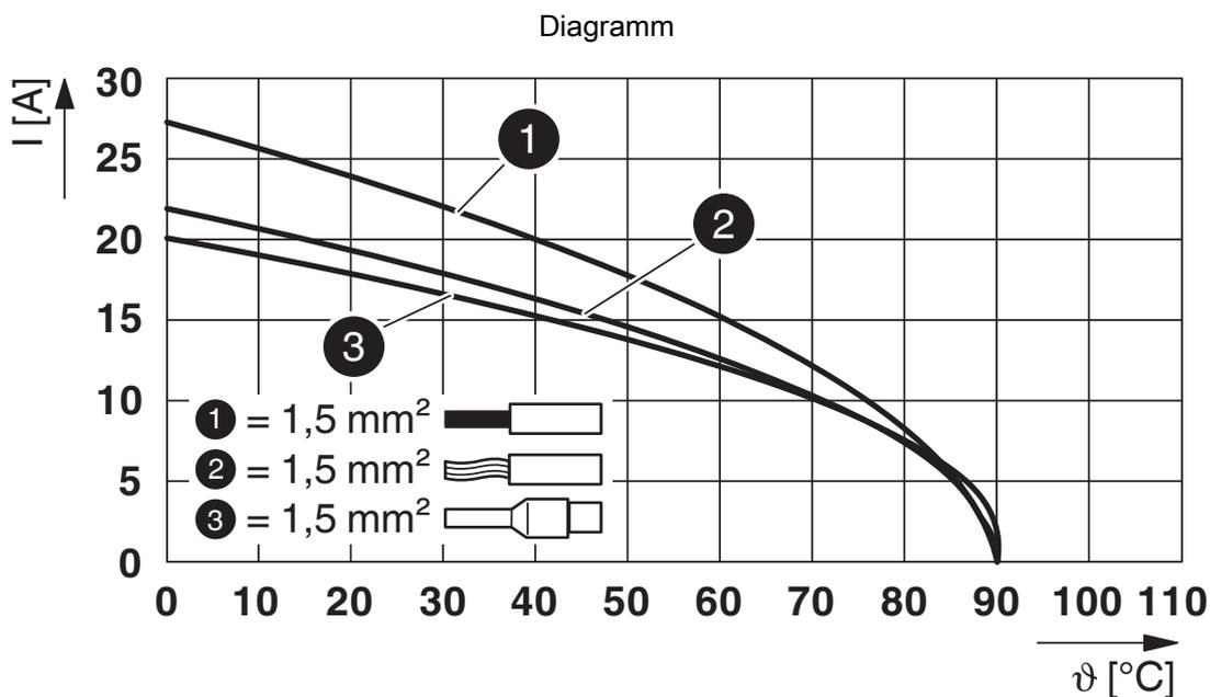
Derating-Diagramm für 1,5 mm<sup>2</sup>
