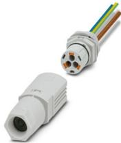
Wanddurchführung, Direktanschluss, Anschlussart: Einzeladern/ Push-in-Anschluss, Polzahl: 2+PE, M20, 0,5 mm<sup>2</sup> ... 2,5 mm<sup>2</sup>, 450 V, 16 A, PA, lichtgrau, Leitungsaußendurchmesser: 6 mm ... 9 mm und 8 mm ... 13 mm, Leitungslänge: 1 m
