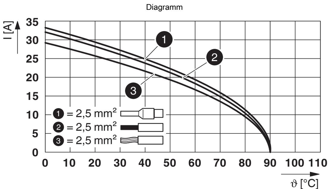
Derating-Diagramm für 2,5 mm<sup>2</sup>
