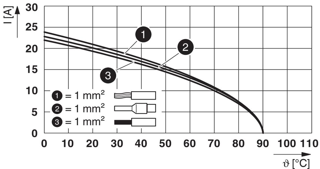
Derating-Diagramm für  $1,0 \text{ mm}^2$
