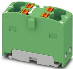
Verteilerblock, intern gebrückt, Nennspannung: 450 V, Nennstrom: 17,5 A, Anzahl der Anschlüsse: 4, Anschlussart: Push-in-Anschluss, Querschnitt: 0,14 mm<sup>2</sup> - 2,5 mm<sup>2</sup>, Montageart: aufrasten auf Tragschienenadapter, Direktmontage mit Flansch, Fliegend, Farbe: grün
