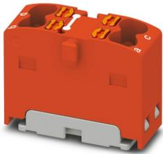
Verteilerblock, intern gebrückt, Nennspannung: 450 V, Nennstrom: 17,5 A, Anzahl der Anschlüsse: 4, Anschlussart: Push-in-Anschluss, Querschnitt: 0,14 mm<sup>2</sup> - 2,5 mm<sup>2</sup>, Montageart: aufrasten auf Tragschienenadapter, Direktmontage mit Flansch, Fliegend, Farbe: rot
