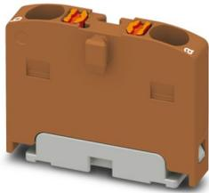
Monoblock, Grundklemme, Nennspannung: 450 V, Nennstrom: 17,5 A, Anzahl der Anschlüsse: 2, Anschlussart: Push-in-Anschluss, Querschnitt: 0,14 mm<sup>2</sup> - 2,5 mm<sup>2</sup>, Montageart: aufrasten auf Tragschienenadapter, Direktmontage mit Flansch, Fliegend, Farbe: braun
