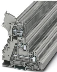
Sicherungsreihenklemme, Art der Sicherung: Glas / Keramik / ..., Sicherungstyp: G / 5 x 20, Nennspannung: 250 V, Thermischer Dauerstrom  $I_{th}$ : 28 A, Anschlussart: Schraubanschluss, Bemessungsquerschnitt: 4 mm<sup>2</sup>, Querschnitt: 0,14 mm<sup>2</sup>- 6 mm<sup>2</sup>, Anschlussart: Schraubanschluss, Bemessungsquerschnitt: 4 mm<sup>2</sup>, Querschnitt: 0,14 mm<sup>2</sup>- 6 mm<sup>2</sup>, Montageart: NS 35/7,5, NS 35/15, Farbe: grau
