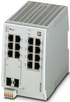
Managed Switch 2000 Serie, 14 RJ45-Ports 10/100 MBit/s, 2 SFP-Ports 100 MBit/s, Schutzart: IP20, Umgebungstemperatur (Betrieb): -40 °C ... 70 °C, Versorgungsspannungsbereich: 12 V DC ... 57 V DC, PROFINET Conformance-Class B, Erweiterter Temperaturbereich, PROFINET-Mode voreingestellt, PROFINET-Status LEDs, Entwicklungsprozess zertifiziert nach IEC 62443-4-1, Kompatibel zu IEC 62443-4-2
