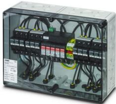
Generatoranschlusskasten für Photovoltaikanlagen bis 1000 V DC zum Anschluss von 2x 3 Strings. Mit Überspannungsschutz (Typ 1/2), Sicherungshaltern und SUNCLIX-DC-Steckverbindern für die Eingangs- und Ausgangsseite (SUNCLIX-Gegenstecker im Lieferumfang).
