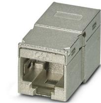
RJ45-Kupplung, Schutzart: IP20, Polzahl: 8, 10 GBit/s, CAT6<sub>A</sub>, Material: Metall, Anschlussart: Kupplung, Kabelabgang: gerade, adapterlose Ausführung, Ethernet
