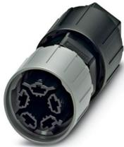
Steckverbinder, Anschlussart: IDC-Anschluss, Polzahl: 4+PE, 1 mm<sup>2</sup> ... 2,5 mm<sup>2</sup>, 690 V, 20 A, PA, schwarz, mit QUICKON-Mutter, Leitungsaußendurchmesser: 9 mm ... 16 mm
