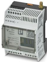
SMS-Relais und Meldemodul, Europa-Version, analoge und digitale Werte über Mobilfunknetz überwachen, Relaisausgänge aus der Ferne schalten, Kommunikation über SMS oder Mobilfunk-Datenverbindung (E-Mail-Versand, App), Versorgungsspannung 10 V ... 60 V DC
