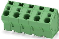
Leiterplattenklemme, Nennstrom: 76 A, Bemessungsspannung (III/2): 1000 V, Nennquerschnitt: 16 mm<sup>2</sup>, Anzahl der Potenziale: 5, Anzahl der Reihen: 1, Polzahl pro Reihe: 5, Artikelfamilie: SPTA 16/, Rastermaß: 15 mm, Anschlussart: Push-in-Federanschluss, Montage: Wellenlöten, Anschlussrichtung Leiter/Platine: 60 °, Farbe: grün, Pin-Layout: Zick-Zack-Pinning W, Pinlänge [P]: 4,1 mm, Anzahl der Lötpins pro Potenzial: 3, Verpackungsart: verpackt im Karton
