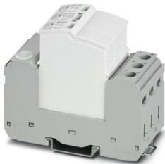
Leckstromfreier steckbarer Überspannungsableiter für 2-polige isolierte und geerdete Gleichspannungssysteme mit linearer Betriebscharakteristik bis 380 V DC, für Tragschienenmontage, 3-poliges Basiselement mit Fernmeldekontakt, drei steckbare temperaturüberwachte Schutzelemente, Statusmeldung an jedem Stecker.
