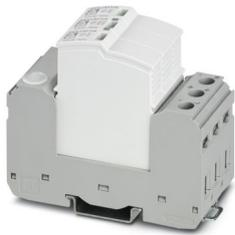
Leckstromfreier steckbarer Überspannungsableiter für 2-polige isolierte und geerdete Gleichspannungssysteme mit linearer Betriebscharakteristik bis 220 V DC, für Tragschienenmontage, 3-poliges Basiselement mit Fernmeldekontakt, drei steckbare temperaturüberwachte Schutzelemente, Statusmeldung an jedem Stecker.
