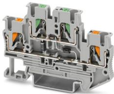
Bauelementreihenklemme, mit integrierter Diode 1N4007, Nennstrom: 0,5 A, Anzahl der Anschlüsse: 4, Anschlussart: Push-in-Anschluss, Bemessungsquerschnitt: 2,5 mm<sup>2</sup>, 1. und 2. Etage, Querschnitt: 0,14 mm<sup>2</sup> - 4 mm<sup>2</sup>, Montageart: NS 35/7,5, NS 35/15, Farbe: grau
