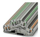
Doppelstockklemme, Nennspannung: 800 V, Nennstrom: 20 A, Anschlussart: Push-in-Anschluss, 1. und 2. Etage, Bemessungsquerschnitt: 2,5 mm², Querschnitt: 0,14 mm² - 4 mm², Montageart: NS 35/7,5, NS 35/15, Farbe: grau
