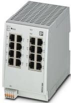
Managed Switch 2000 Serie, 16 RJ45-Ports 10/100/1000 MBit/s, Schutzart: IP20, Umgebungstemperatur (Betrieb): -40 °C ... 70 °C, Versorgungsspannungsbereich: 12 V DC ... 57 V DC, PROFINET Conformance-Class B, Erweiterter Temperaturbereich, PROFINET-Mode voreingestellt, PROFINET-Status LEDs, Entwicklungsprozess zertifiziert nach IEC 62443-4-1, Kompatibel zu IEC 62443-4-2
