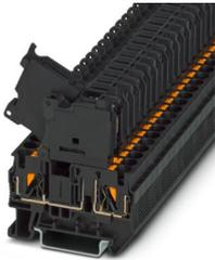
Bauelementreihenklemme, Nennspannung: 250 V, Nennstrom: 6,3 A, Anschlussart: Push-in-Anschluss, Bemessungsquerschnitt: 4 mm<sup>2</sup>, Querschnitt: 0,2 mm<sup>2</sup> - 6 mm<sup>2</sup>, Montage: NS 35/7,5, NS 35/15, Farbe: schwarz
