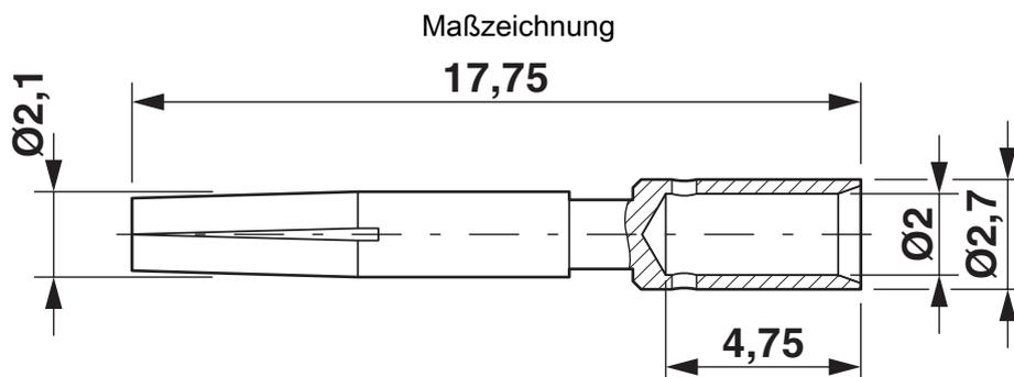
Crimpkontakt, Durchmesser: 1,5 mm
