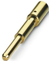
Crimpkontakt, Stift, gedreht, Kontaktdurchmesser: 1,5 mm, Anschlussquerschnitt: 1,5 mm<sup>2</sup> ... 1,5 mm<sup>2</sup>, AWG 14...14, Material Kontakt: CuZn
