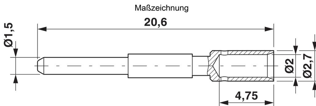
Crimpkontakt, Durchmesser: 1,5 mm
