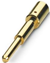
Crimpkontakt, Stift, gedreht, Kontaktdurchmesser: 1,5 mm, Anschlussquerschnitt: 2,5 mm<sup>2</sup> ... 2,5 mm<sup>2</sup>, AWG 14...14, Material Kontakt: CuZn
