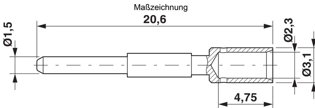
Crimpkontakt, Durchmesser: 1,5 mm
