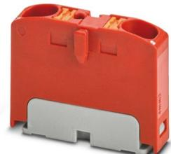
Monoblock, Grundklemme, Nennspannung: 800 V, Nennstrom: 32 A, Anzahl der Anschlüsse: 2, Anschlussart: Push-in-Anschluss, Bemessungsquerschnitt: 4 mm<sup>2</sup>, Querschnitt: 0,2 mm<sup>2</sup> - 6 mm<sup>2</sup>, Push-in-Anschluss, Montageart: aufrasten auf Tragschienenadapter, Direktmontage mit Flansch, Fliegend, Farbe: rot
