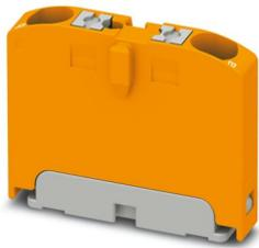
Monoblock, Grundklemme, Nennspannung: 450 V, Nennstrom: 24 A, Anzahl der Anschlüsse: 2, Anschlussart: Push-in-Anschluss, Querschnitt: 0,14 mm<sup>2</sup> - 4 mm<sup>2</sup>, Montageart: aufrasten auf Tragschienenadapter, Direktmontage mit Flansch, Fliegend, Farbe: orange
