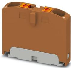
Monoblock, Grundklemme, Nennspannung: 450 V, Nennstrom: 24 A, Anzahl der Anschlüsse: 2, Anschlussart: Push-in-Anschluss, Querschnitt: 0,14 mm<sup>2</sup> - 4 mm<sup>2</sup>, Montageart: aufrasten auf Tragschienenadapter, Direktmontage mit Flansch, Fliegend, Farbe: braun
