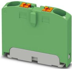
Monoblock, Grundklemme, Nennspannung: 450 V, Nennstrom: 24 A, Anzahl der Anschlüsse: 2, Anschlussart: Push-in-Anschluss, Querschnitt: 0,14 mm<sup>2</sup> - 4 mm<sup>2</sup>, Montageart: aufrasten auf Tragschienenadapter, Direktmontage mit Flansch, Fliegend, Farbe: grün
