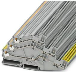
Mehrstockklemme, Nennspannung: 500 V, Nennstrom: 15 A, Anschlussart: Push-in- / Steckanschluss, 1. Etage, Bemessungsquerschnitt: 1,5 mm<sup>2</sup>, Querschnitt: 0,14 mm<sup>2</sup> - 1,5 mm<sup>2</sup>, Montageart: NS 35/7,5, NS 35/15, Farbe: grau
