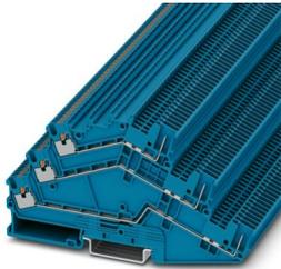
Mehrstockklemme, Strom und Spannung werden durch den eingesetzten Stecker bestimmt., Nennspannung: 500 V, Nennstrom: 15 A, Anschlussart: Push-in- / Steckanschluss, 1. Etage, Bemessungsquerschnitt: 1,5 mm<sup>2</sup>, Querschnitt: 0,14 mm<sup>2</sup> - 1,5 mm<sup>2</sup>, Montageart: NS 35/7,5, Farbe: blau
