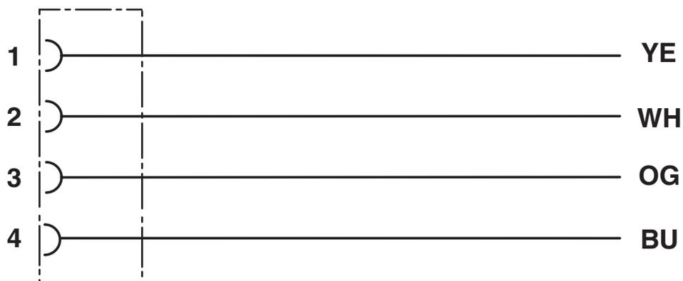
Kontaktbelegung der M12-Buchse
