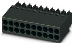
Leiterplattenstecker, Nennquerschnitt: 0,75 mm<sup>2</sup>, Farbe: schwarz, Nennstrom: 6 A, Bemessungsspannung (III/2): 160 V, Kontaktoberfläche: Au, Kontaktart: Buchse, Anzahl der Potentiale: 28, Anzahl der Reihen: 2, Polzahl: 14, Anzahl der Anschlüsse: 28, Artikelfamilie: DMCC 0,5/...-ST, Rastermaß: 2,54 mm, Anschlussart: Crimpanschluss, Anschlussrichtung Leiter/Platine: 0 °, Stecksystem: COMBICON DFMC 0,5, Verriegelung: ohne, Befestigungsart: ohne, Verpackungsart: verpackt im Karton
