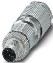
Power-Steckverbinder, Leistung, 5-polig, geschirmt, Stecker gerade M12, Kodierung: K, Crimpanschluss, Rändelmaterial: Zinkdruckguss, verzinkt, Leitungsaußendurchmesser 8 mm ... 13 mm, ohne Crimpkontakte
